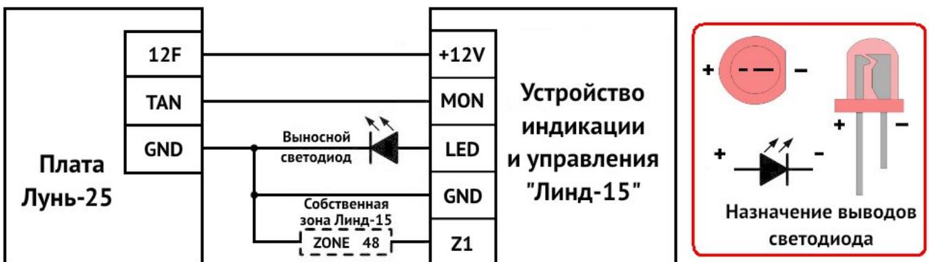
Рисунок 23. Схема подключения УИУ к ППК «Лунь-25»
