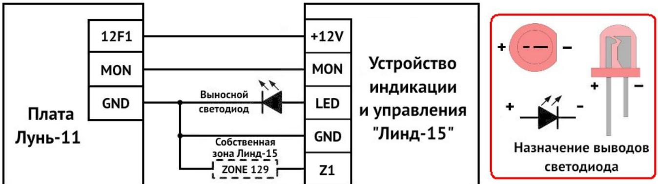
Рисунок 22. Схема подключения УИУ к ППК «Лунь-11»
