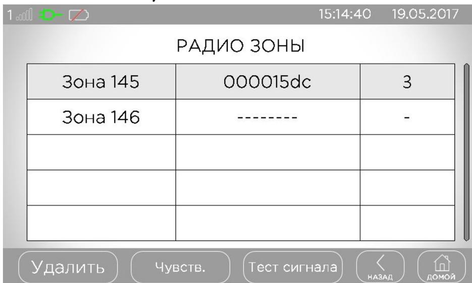
Рисунок 19. Отображение зарегистрированных радиодатчиков
