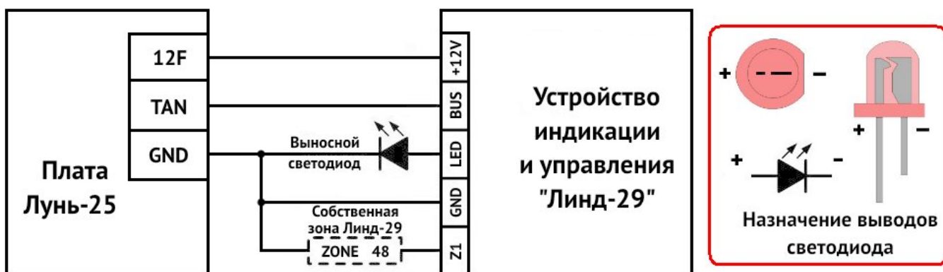
Рисунок 6. Схема подключения к ППК «Лунь-25»
