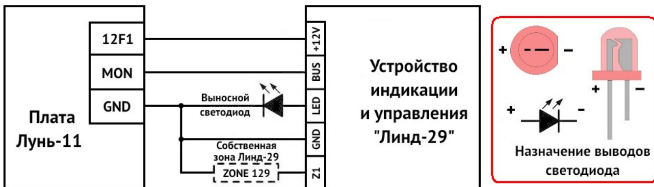
Рисунок 5. Схема подключения УИУ к ППК «Лунь-11»
