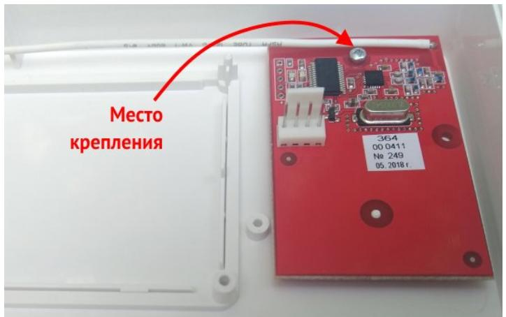
Рисунок 19. Радиоприемник «Lun RKI v3» в корпусе ППКОП
