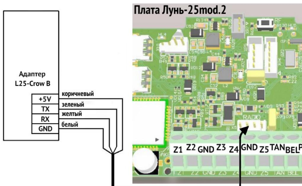
Рисунок 29. Схема подключения адаптера «L25-Crow B»
