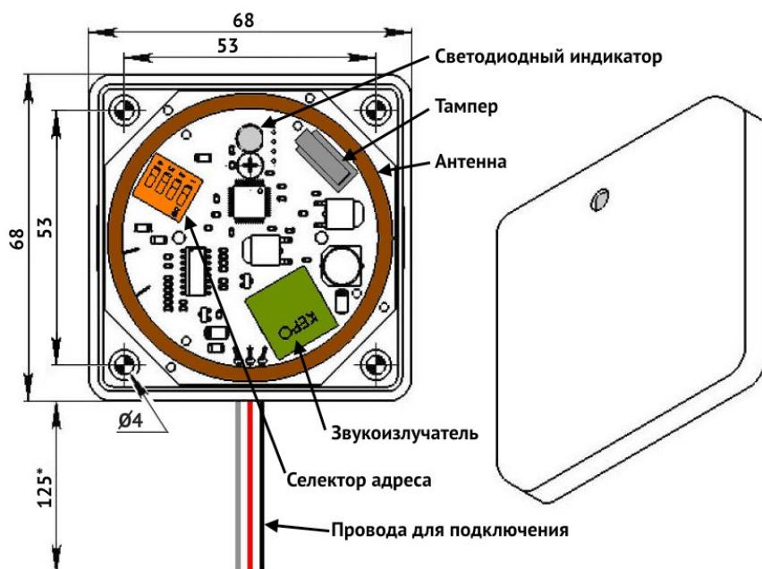
Рисунок 15. Внешний вид и устройство УИУ «Линд-ЕМ»
