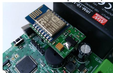
Рисунок 23. Установка WiFi модуля
