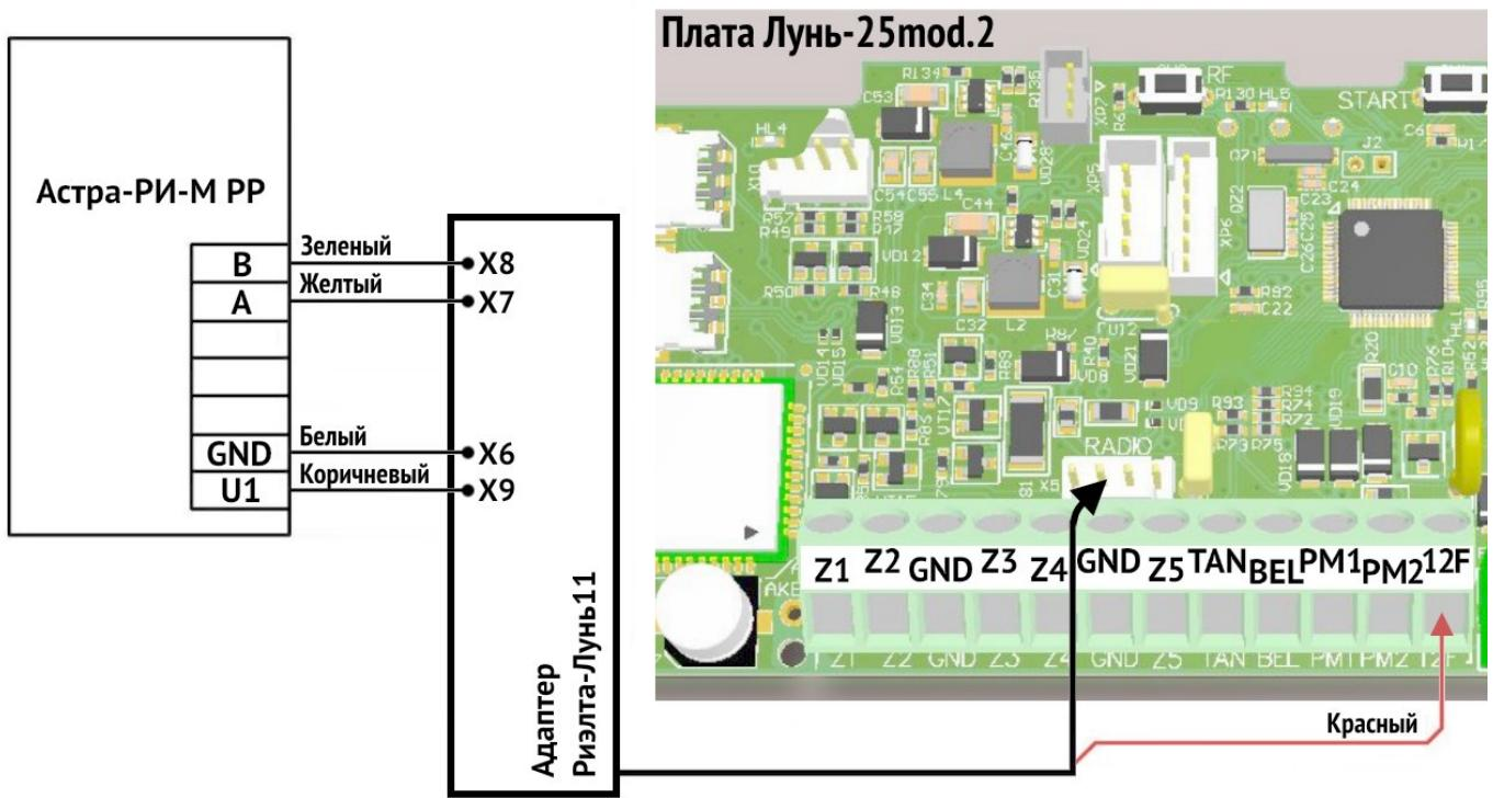
Рисунок 28. Схема подключения РПУ «Астра РИ-М РР»
