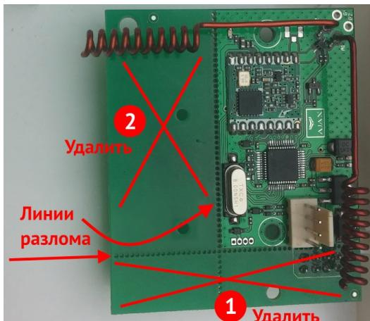
Рисунок 20. Подготовка радиоприемника Ajax «uartBridge»
