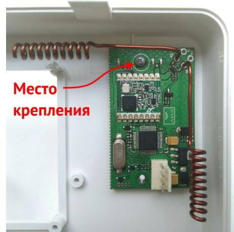
Рисунок 21. Радиоприемник Ajax «uartBridge» в корпусе ППКОП
