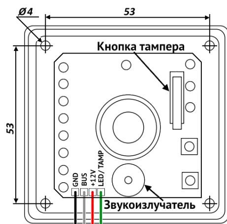
Рисунок 14. Вид УИУ «Линд-7», «Линд-11ТМ» без крышки
