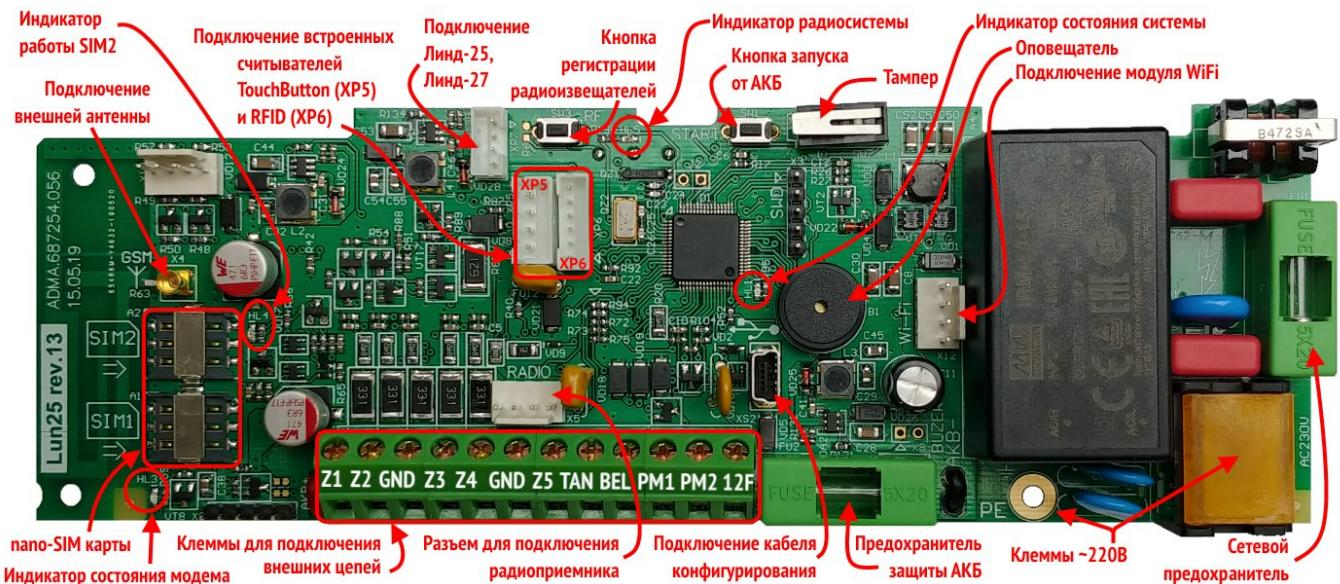
Рисунок 4. Расположение элементов на плате ППКОП
