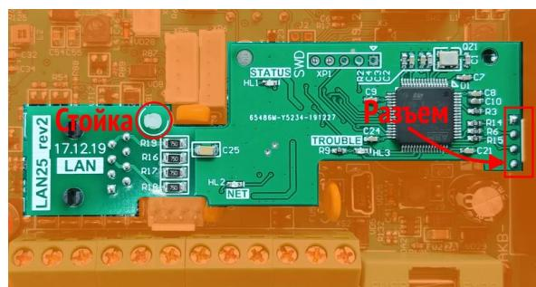
Рисунок 24. Установка модуля «LanCom25»
